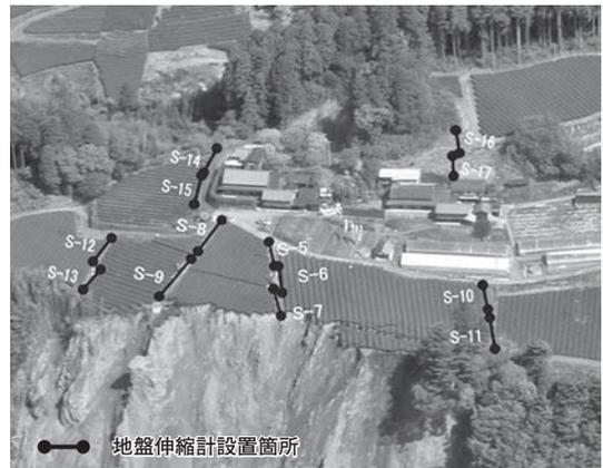
写真－3 崩壊後の地すべり挙動の監視（H25.5.13撮影）
