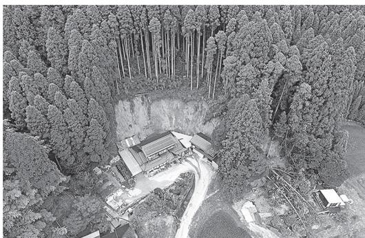
写真-5 家屋裏の斜面崩壊状況
