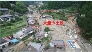
崩壊地や渓流からの土砂流出は限られているが、本川には大量の土砂が堆積している。
