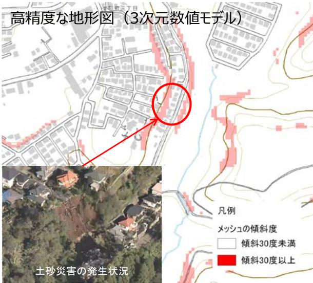
基礎調査に高精度な地形データを用いることで、警戒区域の精度を向上
