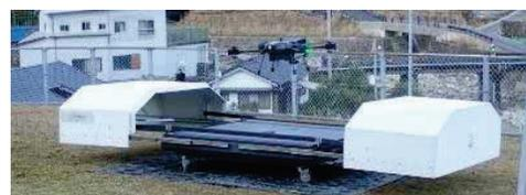
給電やデータ伝送を行うドローンポートを設置し、UAVを用いた監視を自動化
