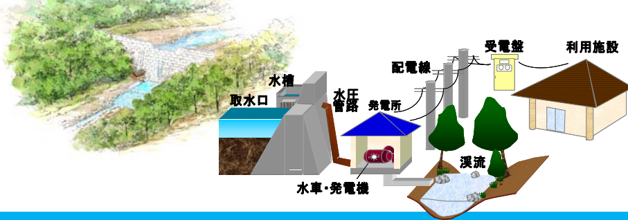
砂防堰堤を活用しての発電イメージと事例
