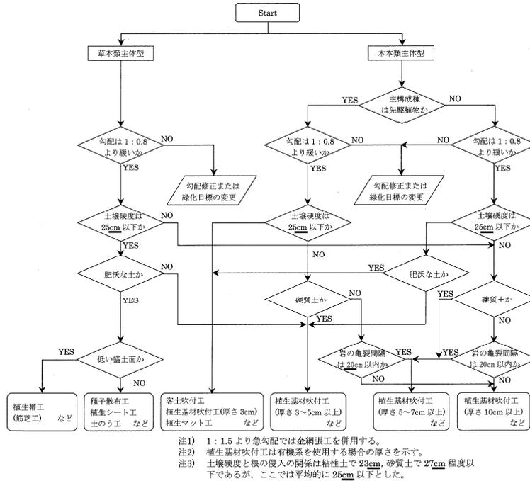
図5-2 播種による植生工の選定フロー
