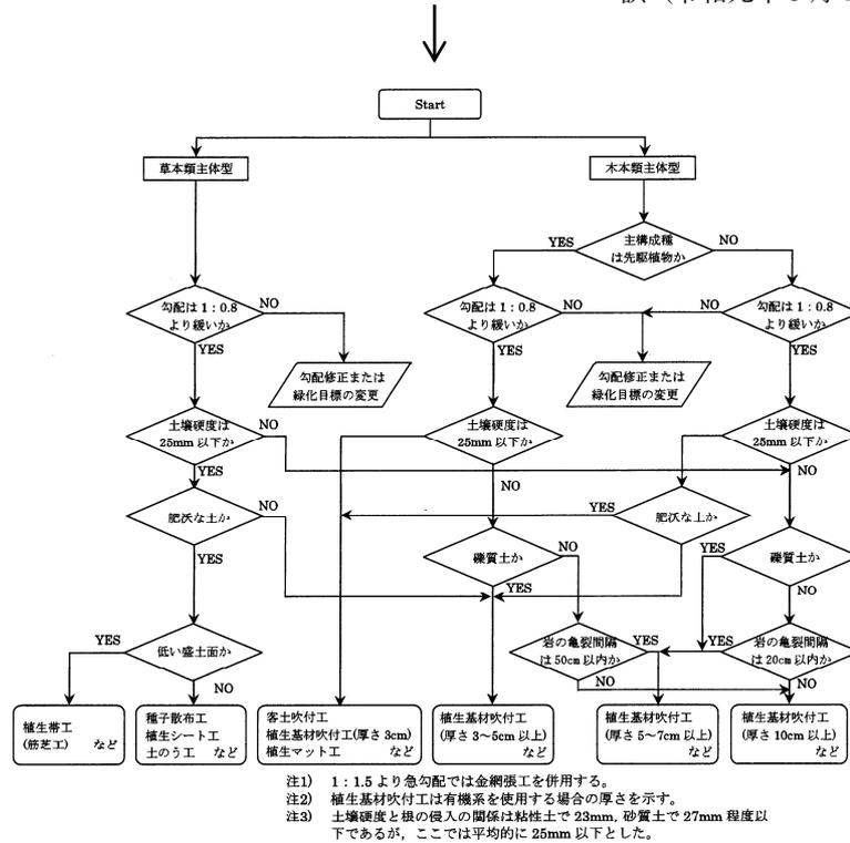
図5-2 播種による植生工の選定フロー
