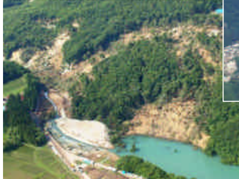
河道閉塞(天然ダム)における仮排水路の設置状況(岩手県一関市市野々原地区)
